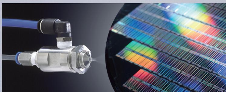
・従来の一般的なノズルは噴霧口径が小さく、微細な粒子は小さな噴霧口から噴霧されると考えられてきましたが、アトマックスノズルは、小流量噴霧のノズルでも口径が1mm以上、大流量噴霧のノズルでは口径が6mm以上で非常に大きく、従来ノズルの噴霧口径に比較すると10倍から200倍であるため、様々な性状の液体微粒化において、目詰まりをおこしません。またノズル構造内の流路はストレートです。
